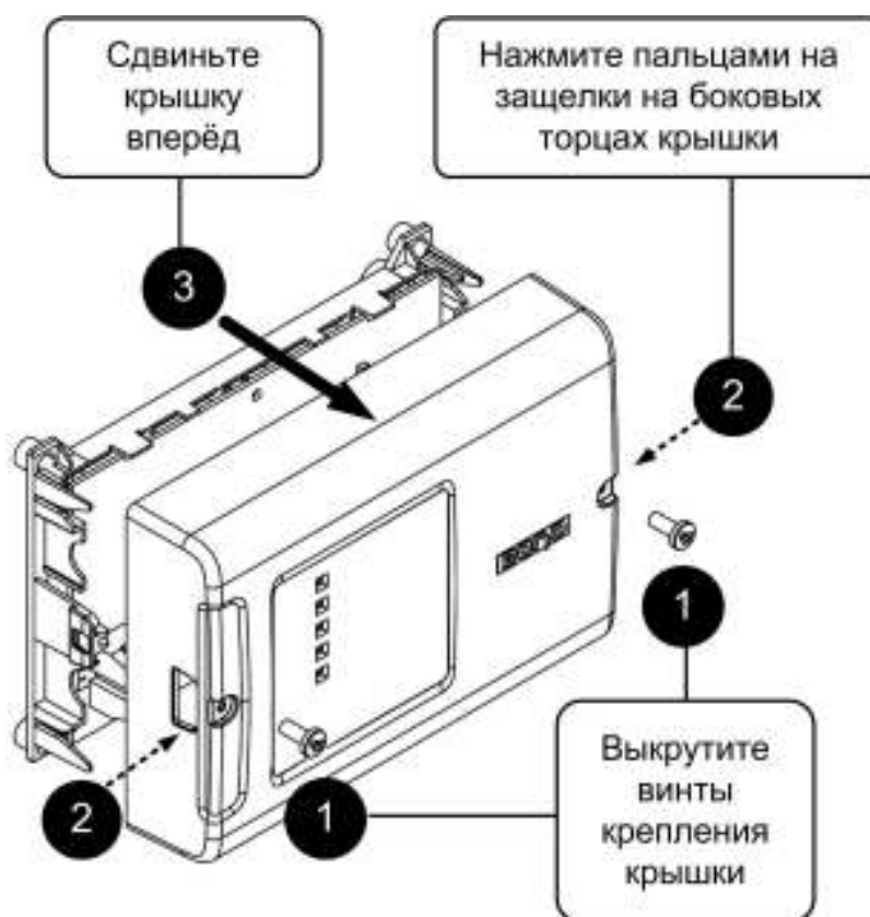
Рисунок 2.2.2 – Снятие крышки корпуса блока
