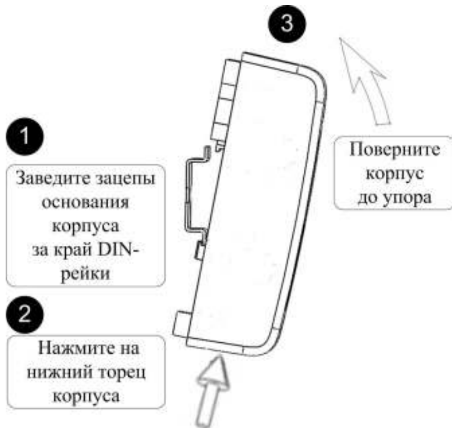
Рисунок 2.2.3 – Схема установки блока на DIN рейку.
