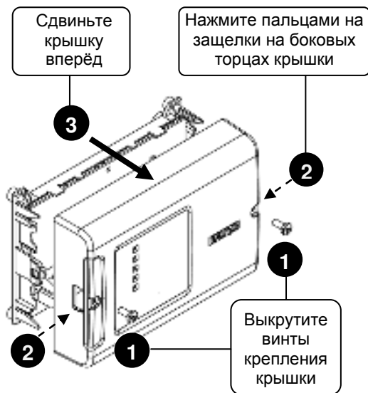
Рисунок 2. Снятие крышки блока
